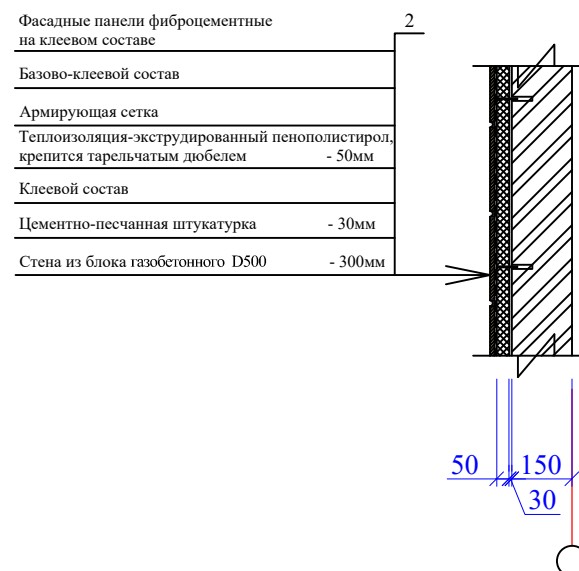
Отделка стен фасадов поз. 2: вариант отделки декоративной плиткой
